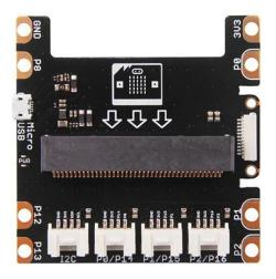
Insérer la carte micro:bit dans le shield mis à votre disposition en prenant garde au sens d'insertion (matrice à leds vers le haut).
